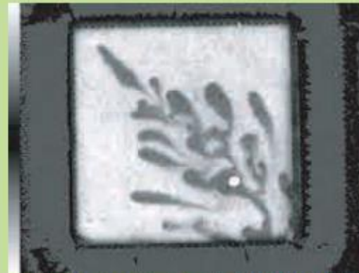
FlipChip アンダーフィル材の測定 (フィラーの粗密の状況を観察)
