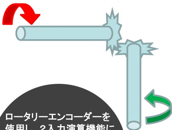
ロータリーエンコーダーを使用し、2入力演算機能による入力軸回転数と出力軸回転数の差を表示
