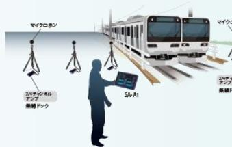
ケーブル敷設不要かつ遠隔測定操作可能な無線測定システム
