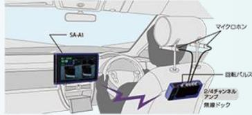
騒音・振動と回転速度の測定システム
