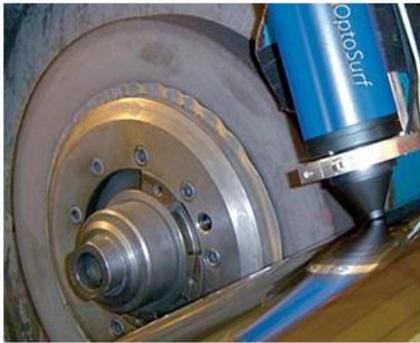
長尺のシャフト研磨における、砥石のドレスのタイミングと真円度を測定
