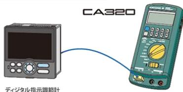
熱電対対応の熱気電力発生可能
