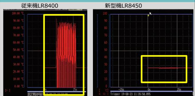
インバーターを動作させると値が大きく変動するのに対して、LR8450では変動が抑えられています。
