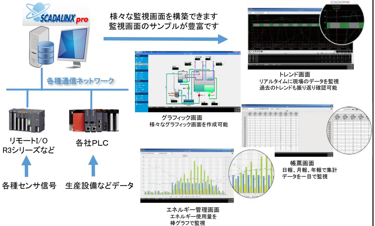
各種センサ、PLCの持つ設備などの情報(ユーティリティー、稼働状況、装置データなど)を収集し、自由度の高い監視画面を作成して監視することができる **工場の見える化ツール** です。
