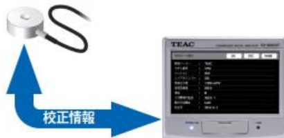
IEEE1451.4 (V1.0)、4Kbit品に対応、クラス2ミックスモードインターフェース
