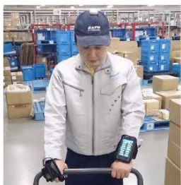
ウェアラブル装着 左手にiPod Touch, 右手にBluetoothスキャナ
