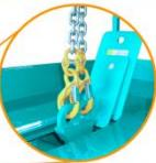
コンプレッサや発電機と同様の一点吊りフックで、トラックへの積み込みが簡単に行えます。
