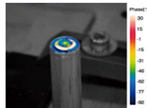
集電子溶接検査画像
